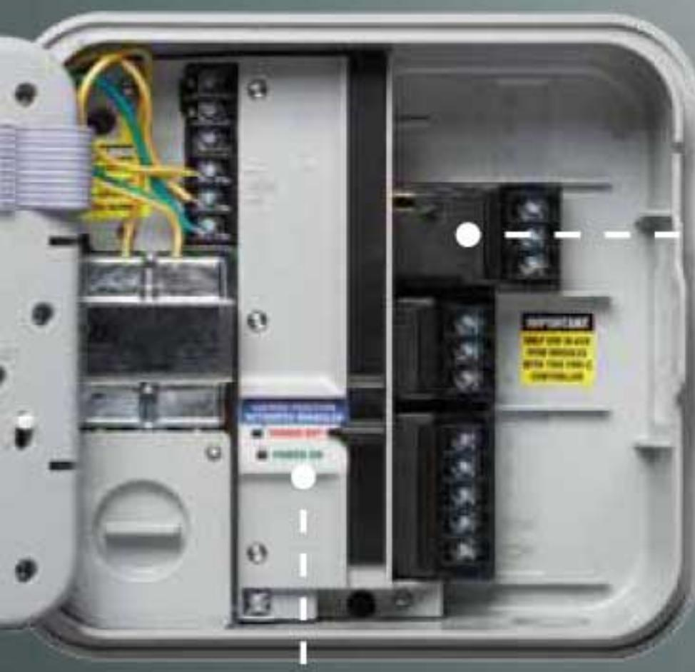
Базовый блок управления на 3 станции, расширяется до 15 станций при помощи модулей PCM
